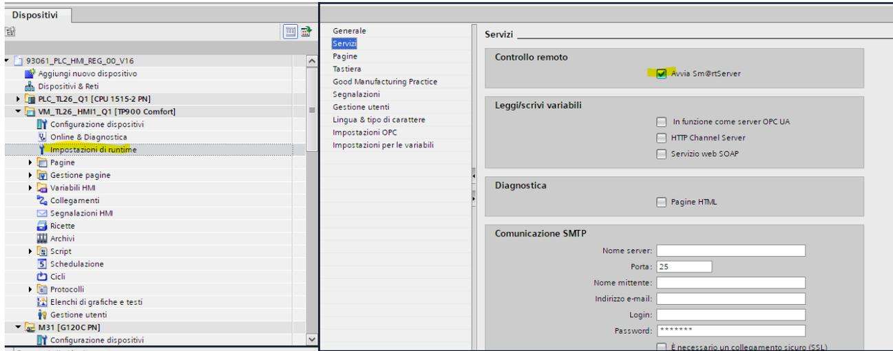
Eeguire una compilazione completa e scaricare sul dispositivo. In questo modo accedendo al menu di seguito evidenziato si potrà selezionare la scheda "Remote"
